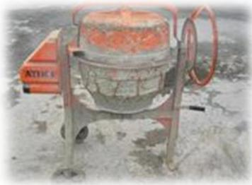
ten gewaschen bzw. das mit Sand, Schotter und Zement verunreinigte Wasser über den öffentlichen Kanal entsorgt. Im Abwasserkanal fließt das Wasser schnell ab, Schotter, Sand und Zement bleiben zurück und trocknen im Kanal wiederum zu Beton aus. Dadurch kommt es dann zu Verstopfungen und nicht unbeträchtlichen Schäden im Kanalsystem.
